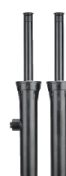
PROS-06-SI & PROS-06 Altura de emergencia: 15 cm Altura total: 22 cm Diámetro expuesto: 5,7 cm Conexión: ½"
